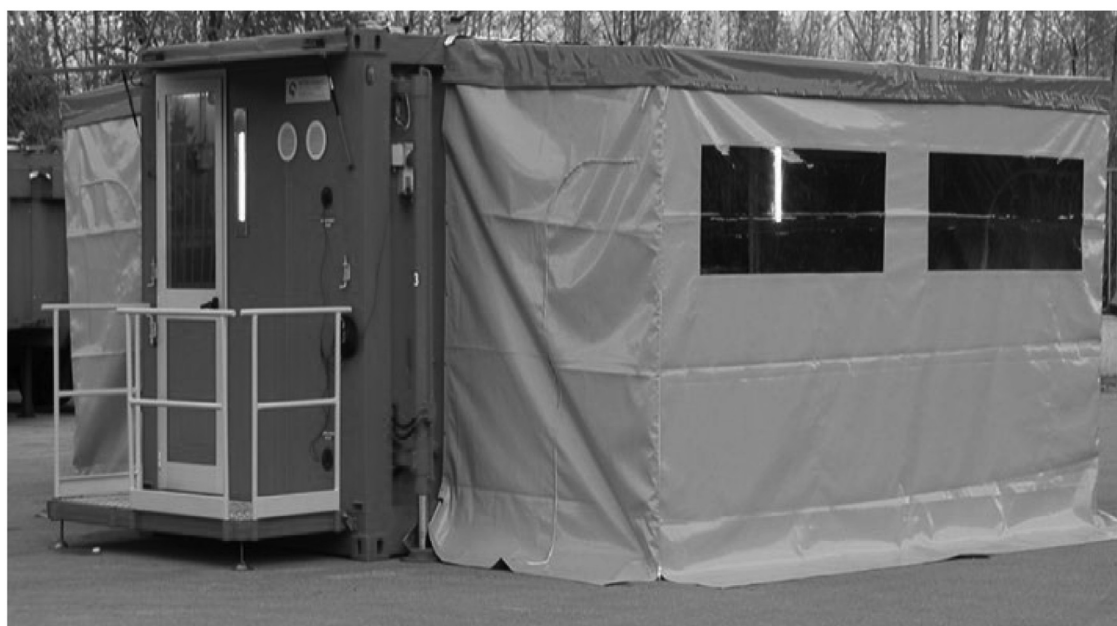
Рис. 4. Деконтамінаційний трейлер, готовий для роботи.
