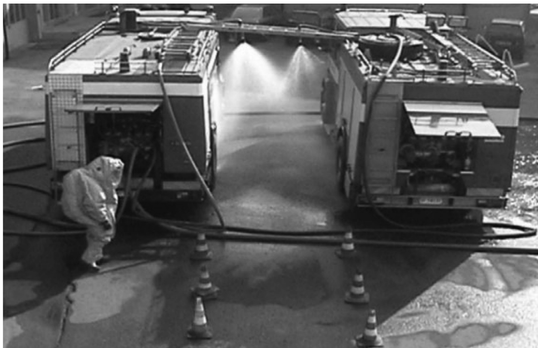
Рис. 2. Система аварійної деконтамінації в роботі.
