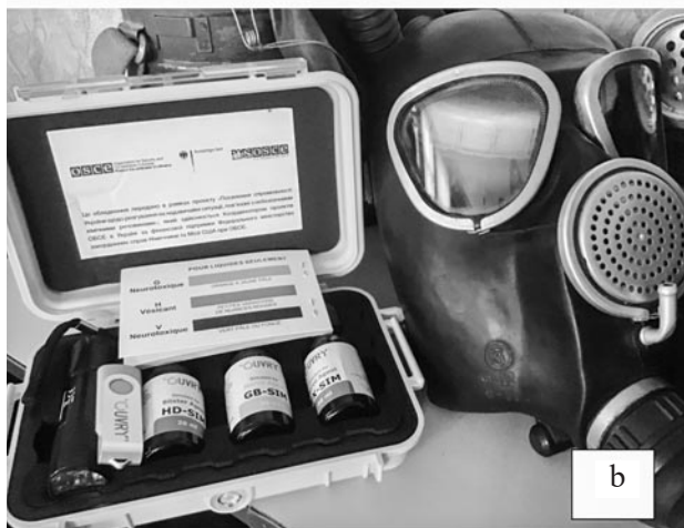
Рис. 1. Тренінг з реагування в умовах ХБРЯ загроз для працівників ДСНС України, м. Харків, 2021 р. а – бригада рятувальників під час деконтамінації лежачого постраждалого; б – набір індикаторного паперу для колориметричної індикації бойових отруйних речовин у польових умовах.
